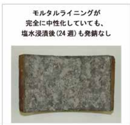
図 21 中性化深さの測定結果
