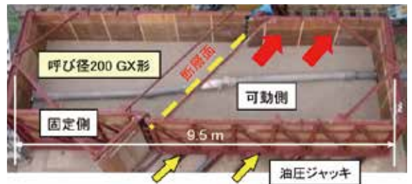
図12 実管を用いた実験
