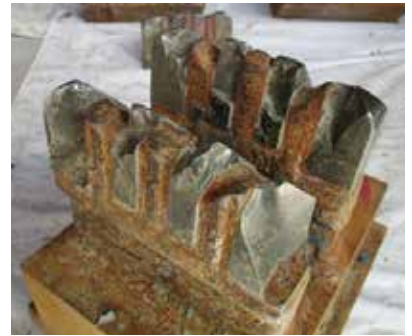
写真5 摩耗したビット (山岳工区)
