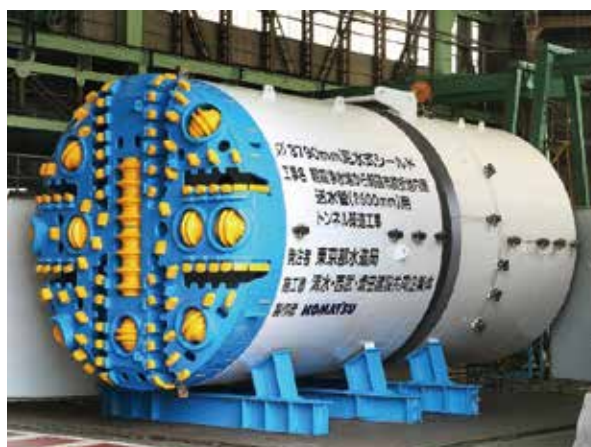
写真1 シールドマシン全景
