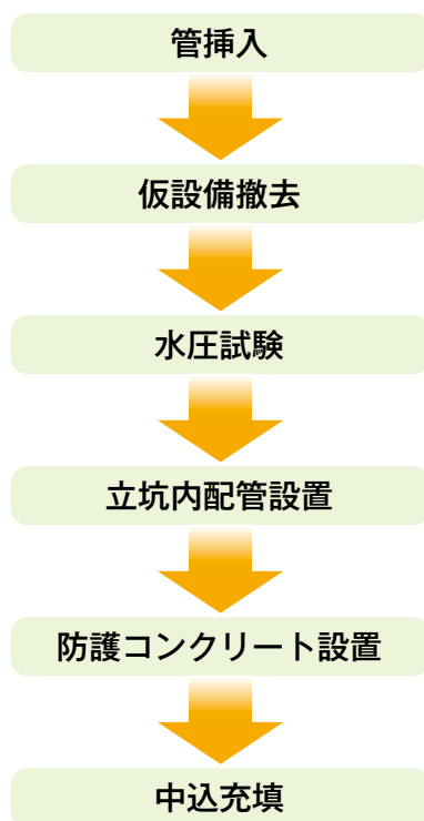
図5 二次覆工工程
