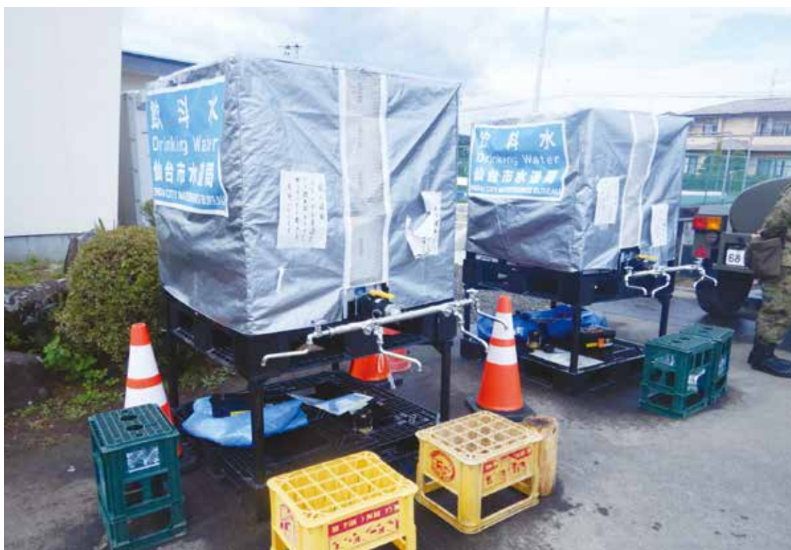
組立式仮設水槽（提供：仙台市）
