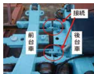
写真4 運搬台車接続状況
