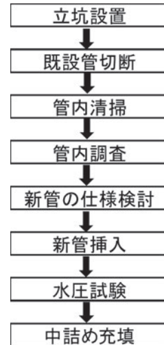
図4 パイプ・イン・パイプ工法手順
