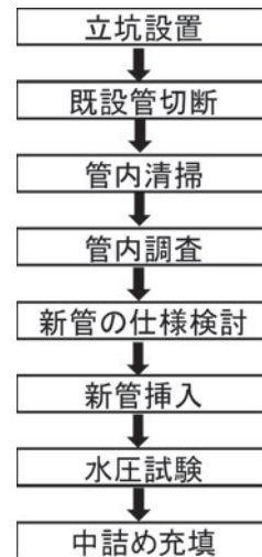
図4 パイプ・イン・パイプ工法手順
