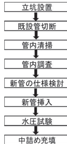
図4 パイプ・イン・パイプ工法手順
