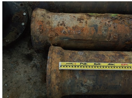
更新工事で上げた14インチ鉄管(明治39年製)
