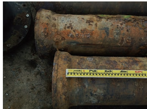
更新工事で引上げた14インチ鉄管(明治39年製)
