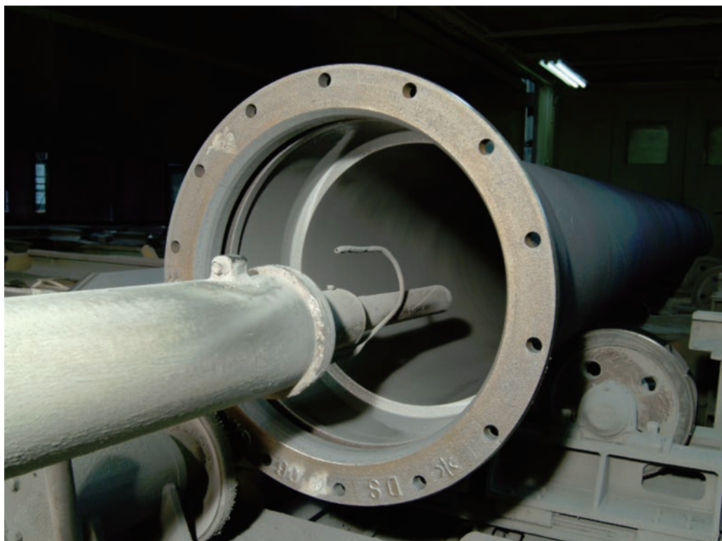
エポキシ樹脂粉末の吹き付け状況
