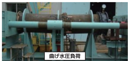
写真4 水密性試験状況
