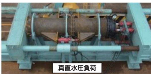
写真4 水密性試験状況
