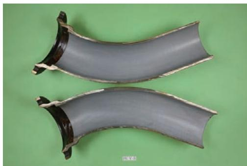
写真2 呼び径 150 45°曲管(使用年数 35年)
