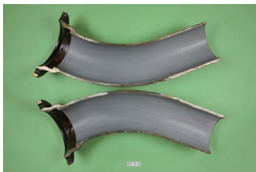
写真2 呼び径 150 45°曲管(使用年数 35年)
