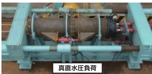
写真4 水密性試験状況
