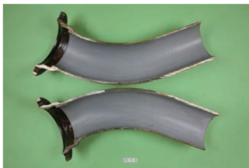
写真2 呼び径 150 45°曲管(使用年数 35年)
