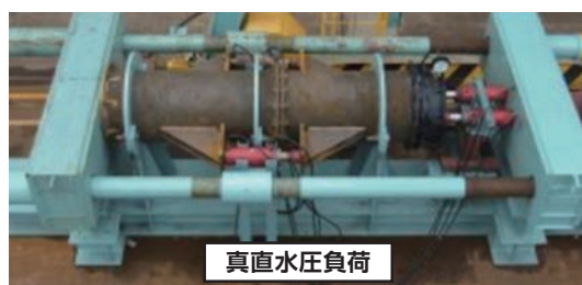
写真4 水密性試験状況
