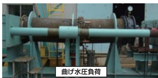
写真4 水密性試験状況
