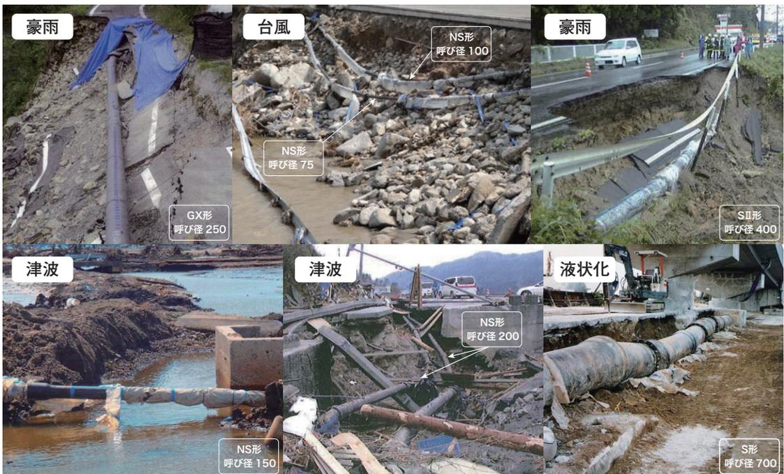
地震災害で被害のなかった「耐震継手ダクトイル鉄管」は、強靱な管体及び耐震性の高い継手性能により「台風・豪雨・津波」など様々な自然災害でも被害を免れた事例が多数あり大規模・多様化する自然災害への有効性からその評価を高めています。
