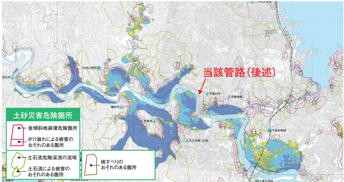
図2 洪水・土石災害ハザードマップ(太田川流域)
