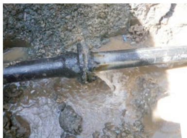
DAφ75 抜け 漏水状況
