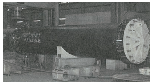
写真 6 離脱防止性能試験状況 (呼び径 1000) 1)
