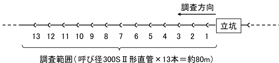
図 23 調査対象管路
