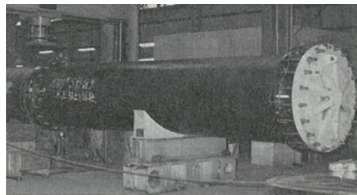
写真 6 離脱防止性能試験状況 (呼び径 1000) 1)
