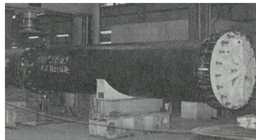
写真 6 離脱防止性能試験状況 (呼び径 1000) 1)
