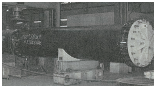
写真 6 離脱防止性能試験状況 (呼び径 1000) 1)
