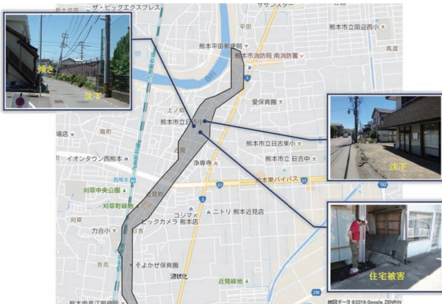
図6 熊本市南区付近の液状化の状況
