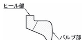
図4 NS形E種管直管用ゴム輪形状
