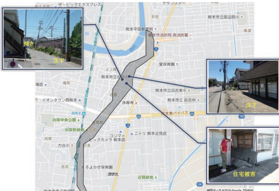
図6 熊本市南区付近の液状化の状況
