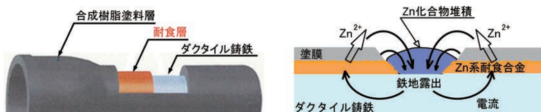
図1 耐食亜鉛系塗装の防食メカニズム
