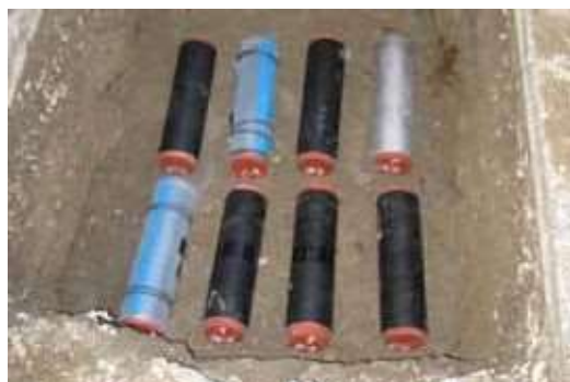
図12 海成粘土での埋設試験
