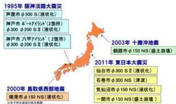
図5 耐震管路の挙動調査実績
