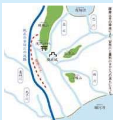
家康公が薩摩土手などの大規模な土木事業を実施して安倍川の治水を行いました。
