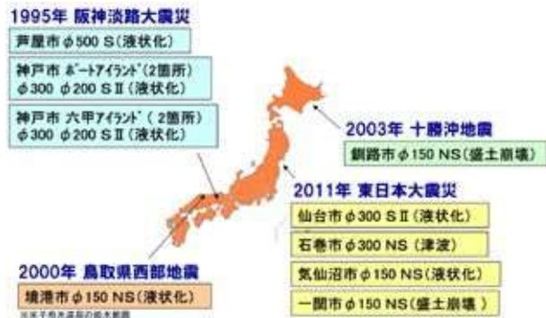
図5 耐震管路の挙動調査実績
