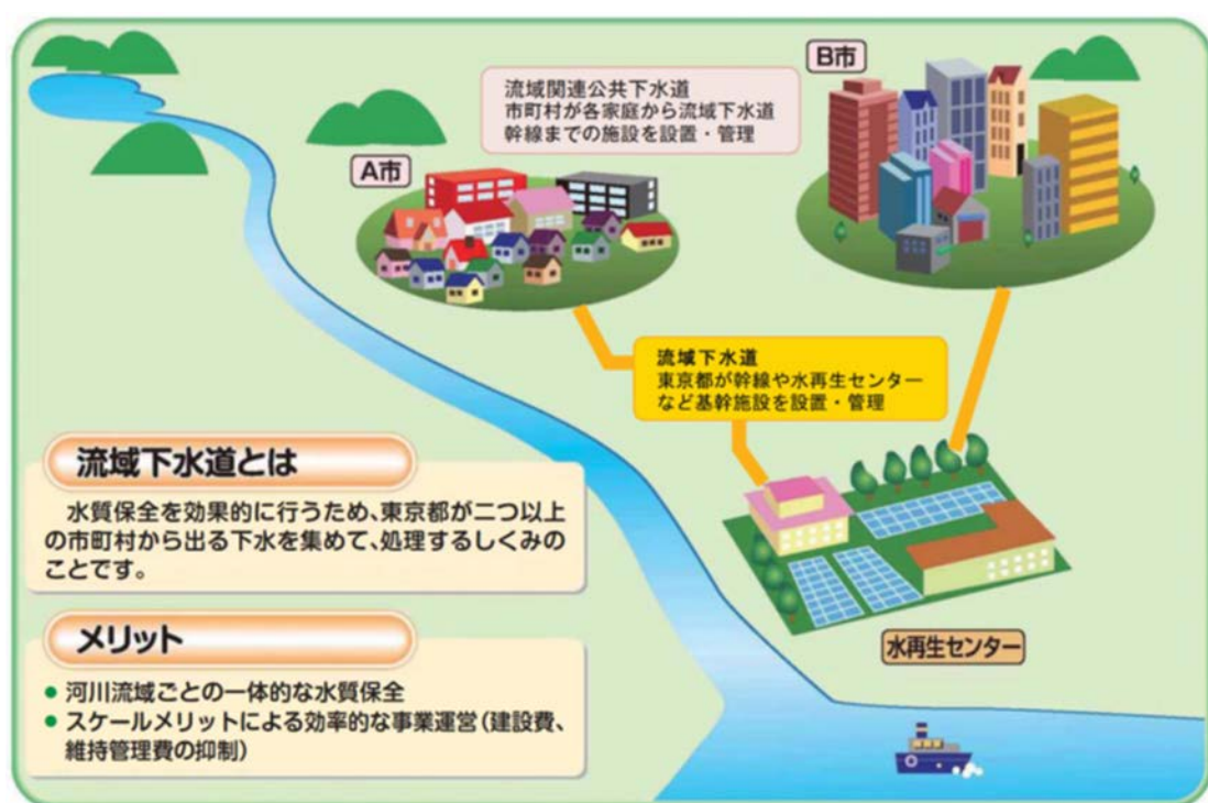
図1 流域下水道の仕組み
