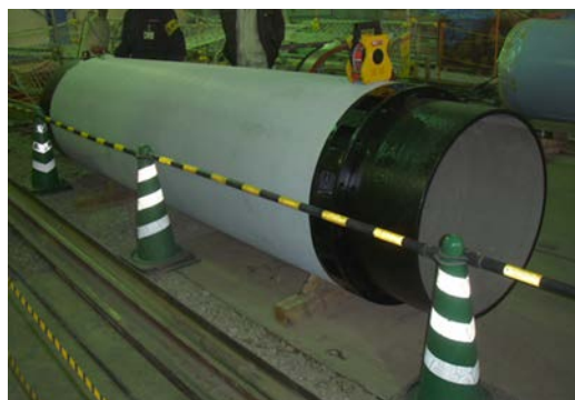
写真1 U形推進工法用ダクトイル鉄管
