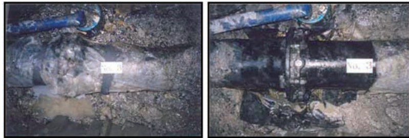
写真No1 埋設20年後の管外面の状況
