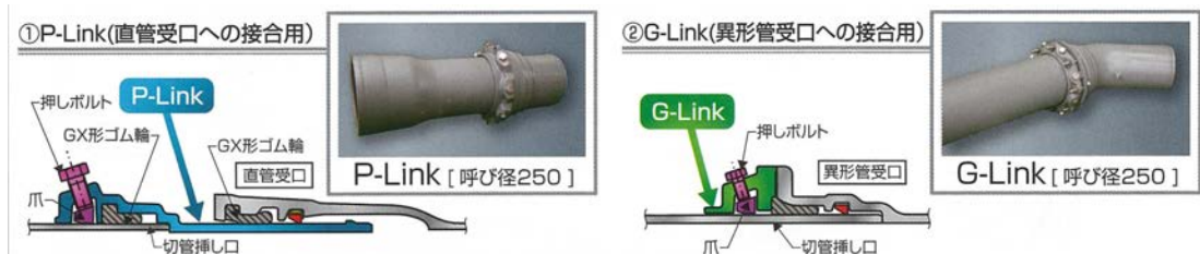
図2 GX形の切管方法
