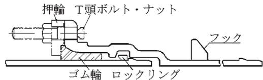
※フックは、曲管、乙字管の挿し口側の管体部の左右2か所に設ける。
