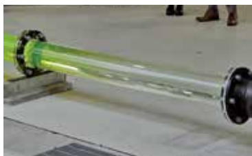
水の動きを確認するためのアクリル管
