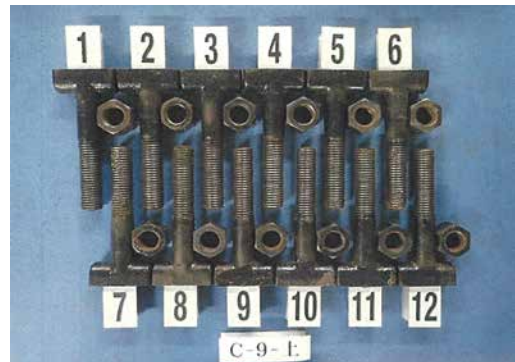
写真12 ナイロン被覆 DCI 製ボルトナット
