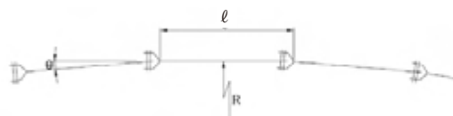
図4 曲率半径と継手屈曲角度の関係
