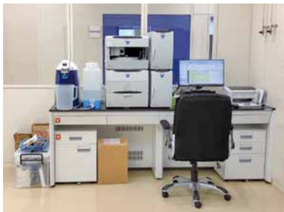
水中の硬度等イオン類を測定します(イオンクロマトグラフ装置)
