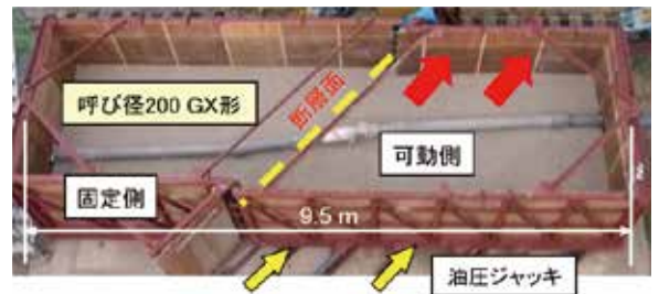
図12 実管を用いた実験
