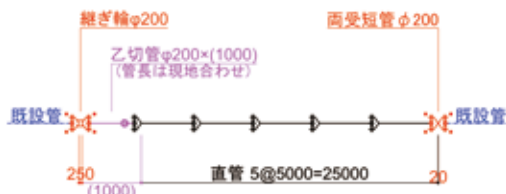
図8 本設管 管割図
