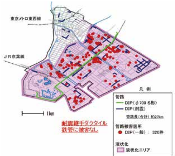
図2 液状化による管路被害集中箇所でも被害がなかった耐震継手ダクタイトイル鉄管 (東日本大震災、浦安市)
