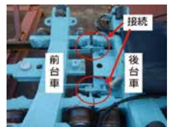
写真4 運搬台車接続状況
