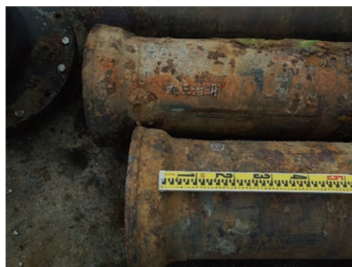
更新工事で上げた14インチ鉄管(明治39年製)
