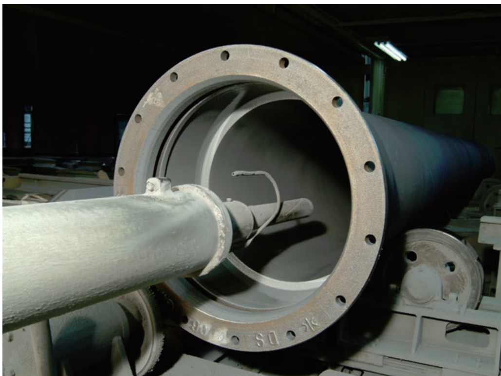
エポキシ樹脂粉末の吹き付け状況
