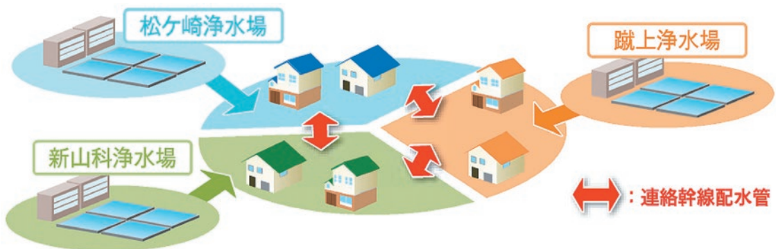
図3 連絡幹線配水管による給水のバックアップ機能の強化イメージ
