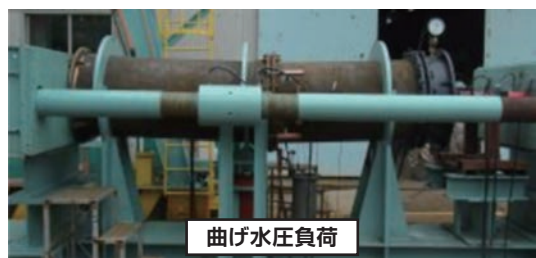
写真4 水密性試験状況
