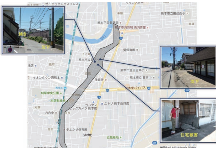
図6 熊本市南区付近の液状化の状況
