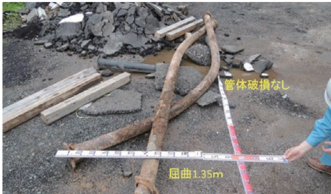
図7 断層横断部の管路被害状況(益城町下陳) ＜呼び径100K形ダクトイル鉄管＞
