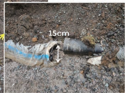
図8 断層横断部の管路被害状況(西原村小森) ＜呼び径200A形ダクトイル鉄管＞
