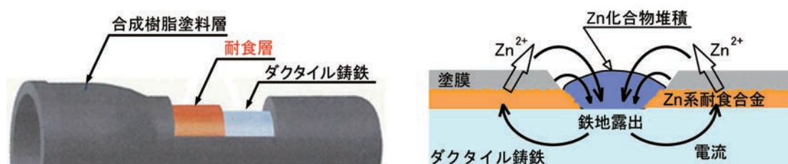
図1 耐食亜鉛系塗装の防食メカニズム
