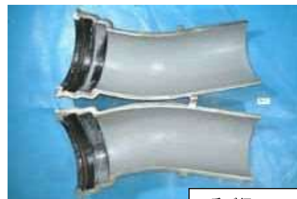
呼び径150 異形管 (23年間使用) 異常は認められず良好
