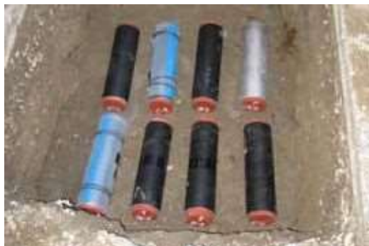
図12 海成粘土での埋設試験
