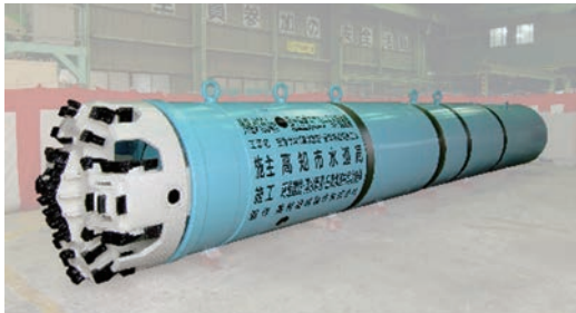
写真1 シールドマシン
