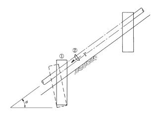
上記のように基礎①がずれた場合、継手部 ②に抜出し力が作用する。管の変位量が継手 の許容伸縮量以内であれば問題はないが、そ れ以上であれば、継手部に引張力が作用する。
