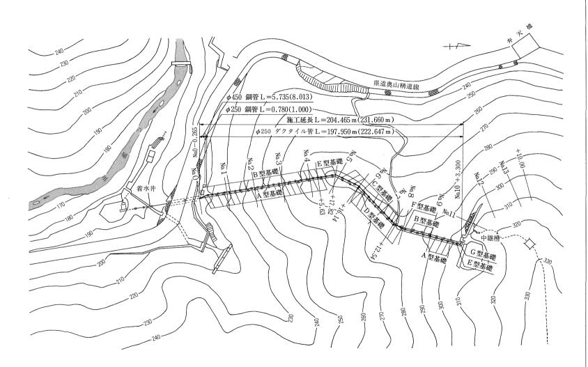
ンクリート暗きょと下流側の呼び径450mmリベット鋼管からなる)を関西電力株式会社から譲り受け、奥山貯水池築造時に応急的な修復を行い、導水管路の一部に転用し現在まで使用してきた。
