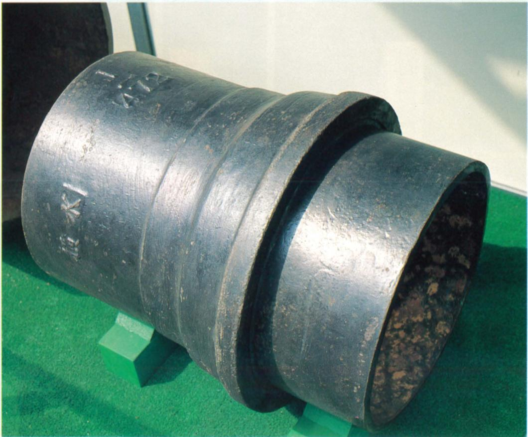
横浜市で使用されていた、明治28年～30年にベルギーで製造された18インチ(呼び径450mm)の輸入鑄鉄管。パイプの側面に「横水」の鑄出し文字が見える。(久保田鉄工(株)武庫川製造所に展示保存)
