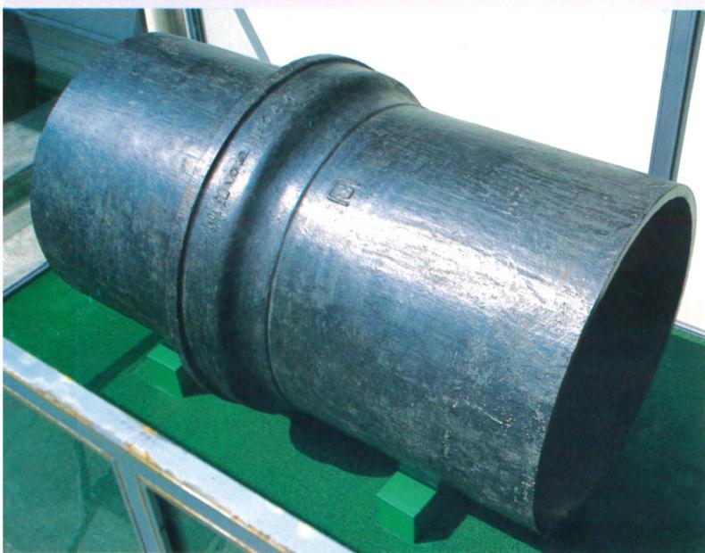
京都市蹴上浄水場から京都御所への送水管に使用されていた、明治43年(1910年)に久保田鉄工で製造された24インチ(呼び径600mm)鑄鉄管。昭和49年に京都紫宸殿の改修工事の際に撤去されたパイプで、宮内庁マークが鑄出しされているのが見える。
