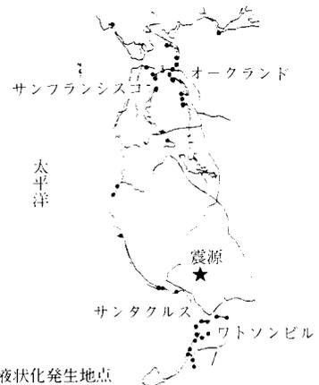
当地震による被害の特徴的なことは、地震動の大きさがさほど大きくないにもかかわらず、マリナーナ地区のように地盤の液状化によって管路に多くの被害が発生したことである。
