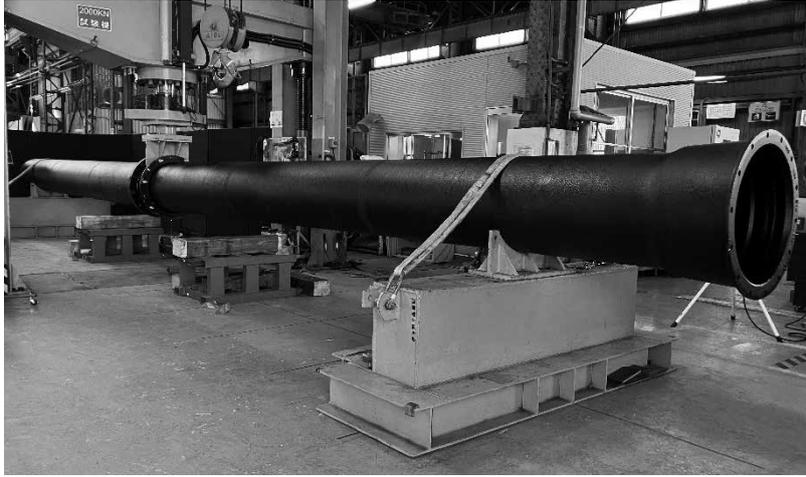
写真6 曲げ強度試験状況(呼び径500)
