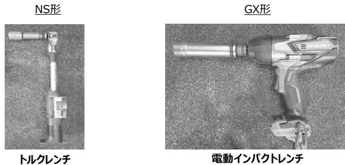
図7 電動工具を用いての接合
