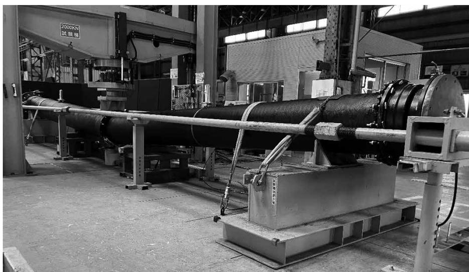
写真2 水密性試験状況(呼び径500屈曲状態)
