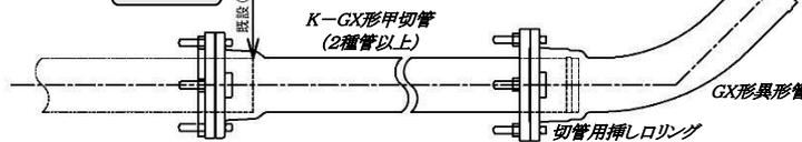
(4) 既設を切断し、GX形異形管挿し口を接合する場合
