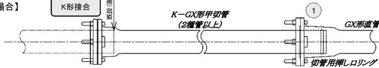
(2) 既設を切断し、GX形直管挿し口を接合する場合
