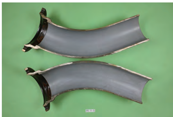
35年間使用された粉体塗膜 (異常認められず良好、呼び径150異形管)
