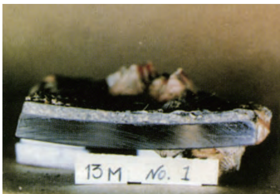
海水浸せぎしたモルタルライニング (浸せき期間：1.5 年) 異常なし
