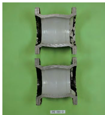
30年間使用された粉体塗膜 (異常認められず良好、呼び径100継ぎ輪)
