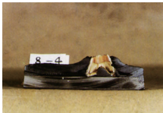
海水浸せぎしたコールタールエナメルライニング (浸せき期間：6 ヶ月) フジツボにより侵食
