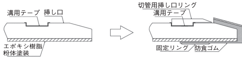
図15 防食ゴムの装着方法（リベットタイプ）
