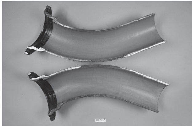
写真5 35年間使用された粉体塗膜 (異常認められず良好、呼び径150 45° 曲管)
